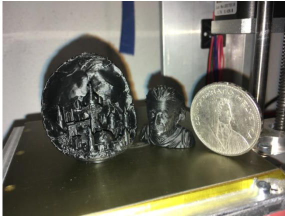
Frösche und weitere Musterteile gedruckt mit 0.15mm Düse und 0.075mm Schichthöhe, Druckzeit bis zu 20 Stunden
