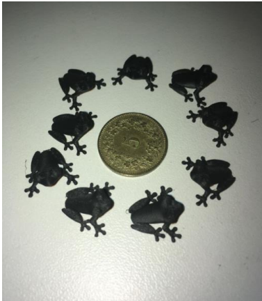
Frösche und weitere Musterteile gedruckt mit 0.15mm Düse und 0.075mm Schichthöhe, Druckzeit bis zu 20 Stunden
