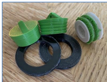
Dichtungselemente: Dichtungen und Stöpsel sind aus einem gummi-artigen Filament hergestellt.
